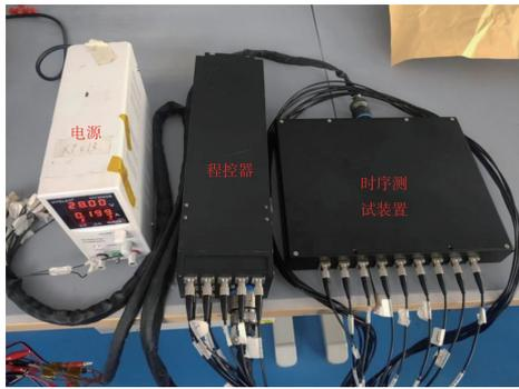
图10 激光时序测试图
