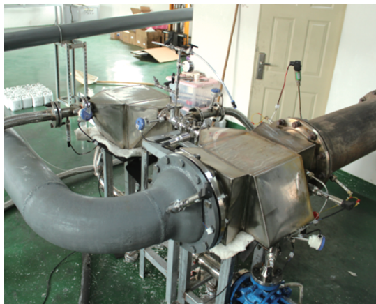
图2 液态金属预冷器原理验证
