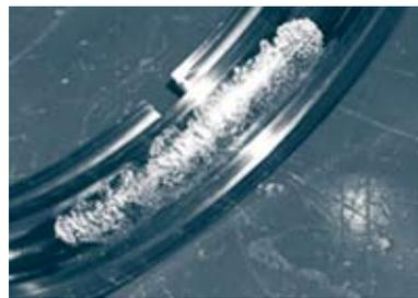
图1 球轴承套圈上发生剥落损伤
