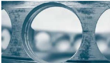
图6 发动机轴承保持架引导面磨损形貌
