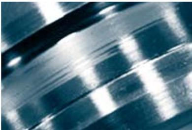
图5 发动机轴承套圈轻载打滑痕迹
