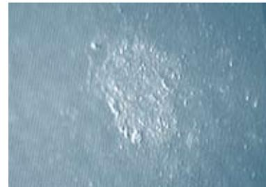
图2 轴承元件上由微粒留下的印痕
