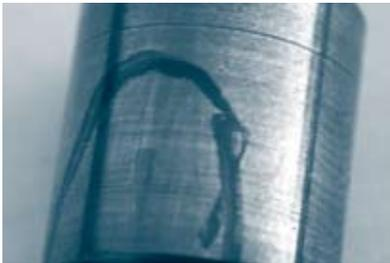
图3 发动机滚子轴承滚动体上的压延印痕
