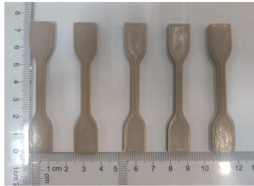
(a) 聚醚醚酮(PEEK)材料测试试样
