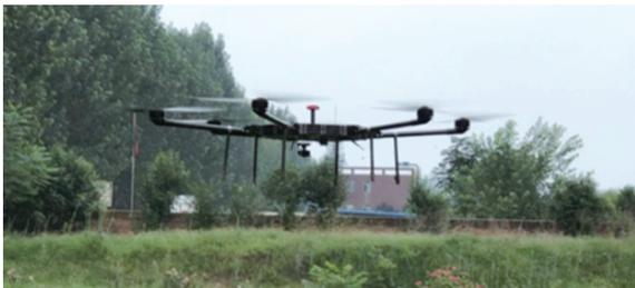
图5 多旋翼无人机平台
