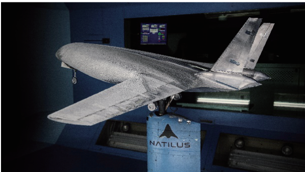
(b) N3.8T货机1/10缩比风洞试验模型
