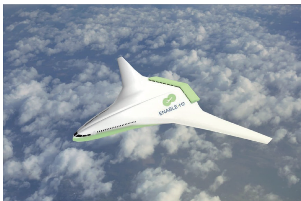
图6 基于美国国家航空航天局N3X-Max Synergy概念的BWB布局氢动力飞机 [14]
