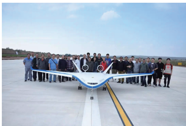
图19 西北工业大学NPU-BWB-300翼身融合缩比验证机
