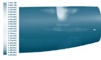
图9 +100^\circ/-150^\circ 风扇罩防火构型下吊挂和机身附近流场静温分布云图
