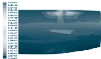
图7 \pm 100^\circ 风扇罩防火构型的流场静温分布云图
