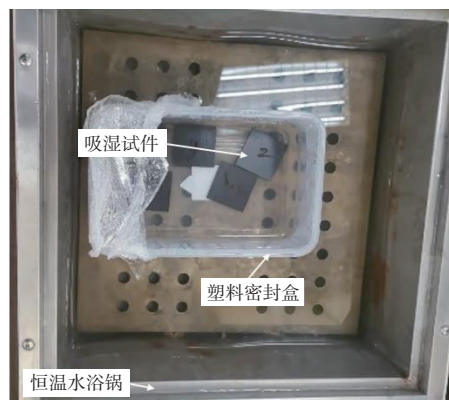
图5 碳纤维增强复合材料层合板吸湿试验 [38]
