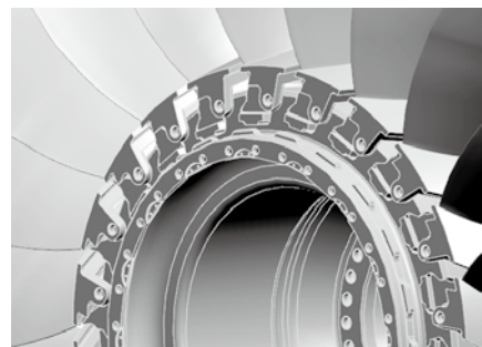
图8 圆弧榫槽及流路板示意图
