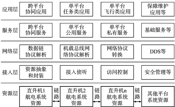
图3 面向云服务的航空电子架构框架
