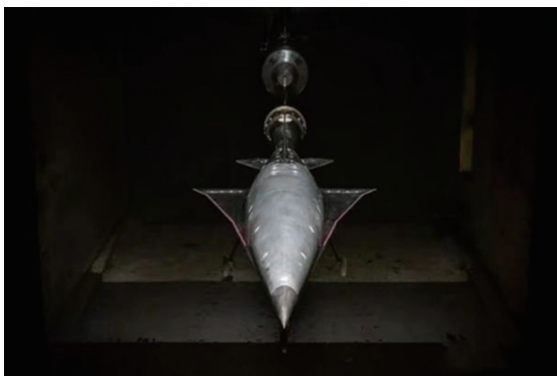
图5 “夸特马”1/10缩比模型风洞试验
