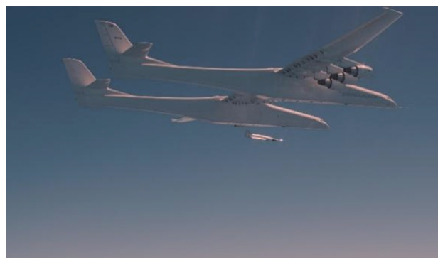
图1 “大鹏”载机成功完成“泰伦-A”高超声速试验飞行器的分离投放
