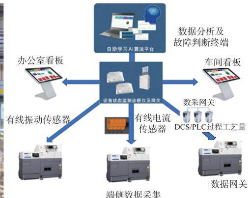
图3 机加中心PHM应用系统数据采集及管理流程
