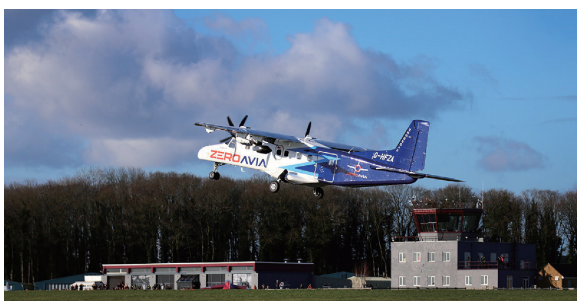
图1 ZeroAvia基于多尼尔228改装的氢燃料电池——锂电池混合动力涡桨飞机
