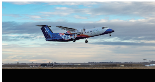
图2 Universal Hydrogen基于Dash-8改装的氢燃料电池混合动力涡桨飞机
