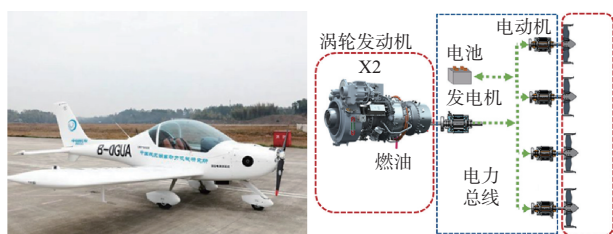
图5 航发研所80kW串联混合电推进验证机(左)和兆瓦级分布式混合电推进系统(右)
