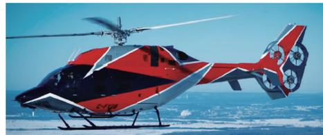
图6 贝尔带有电动尾翼的改装试验版429直升机
