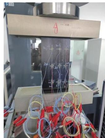
图2 复合材料加筋壁板压缩试验
