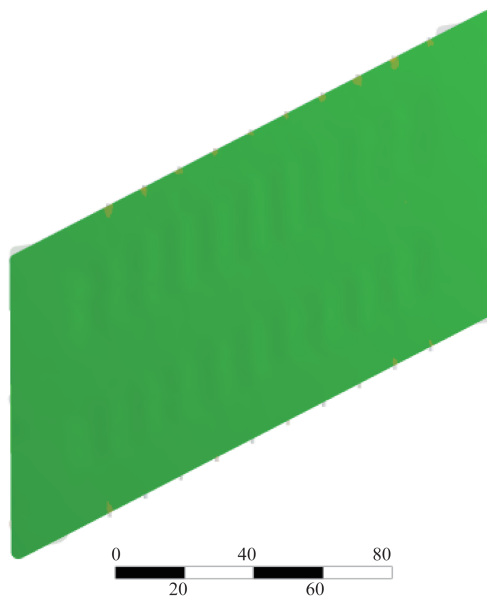
图10 单向纤维增强复合蒙皮法向承载仿真结果(单位:mm)
