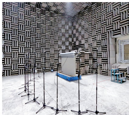
图 3 锯齿结构对转螺旋桨试验现场照
