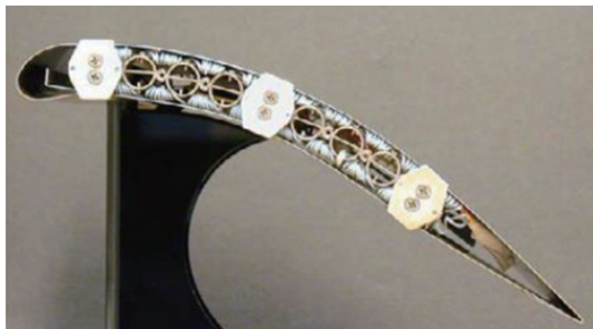
图3 基于仿生脊柱结构的变后缘弯度机翼
