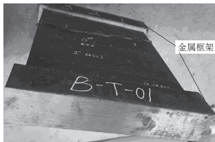
图2 加筋壁板端部灌胶区加装金属框架
