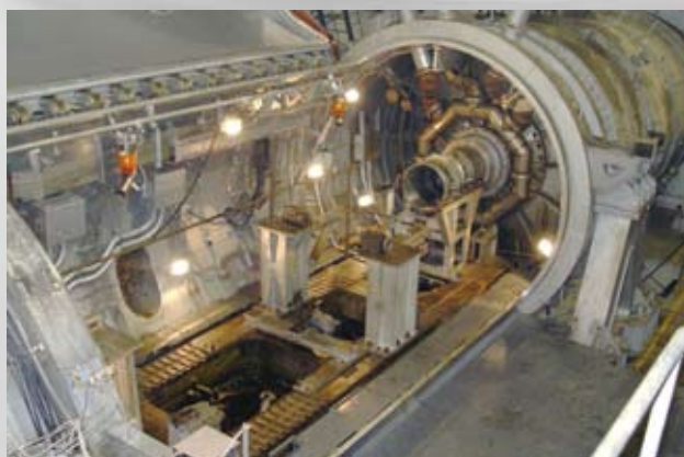
直径3米的高空模拟试验舱
