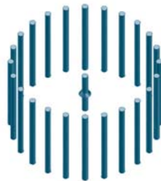
图2 等离子体半波振子天线互耦建模仿真图
