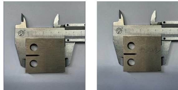
(a) 正常试验件 (b) 氧化处理试验件
