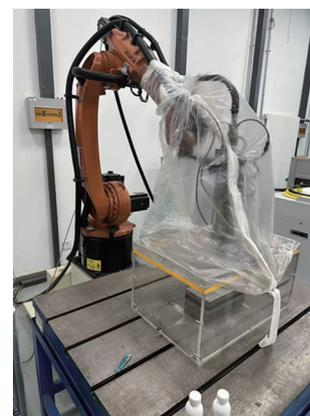
图5 堆焊试验设备
