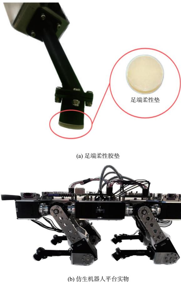
图4 仿生机器人足端柔性胶垫及机器人实物
