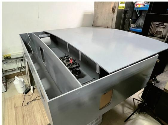
图8 机器人在翼盒内部的检查过程
