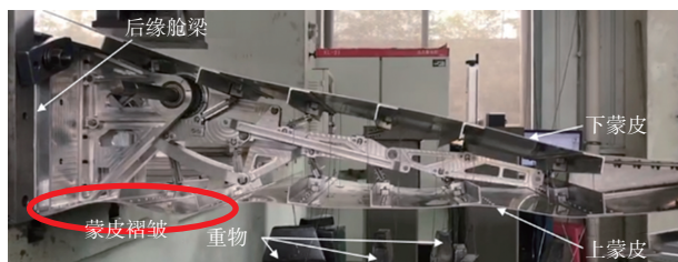
图2 基于刚柔耦合的变弯度机翼后缘承载测试
