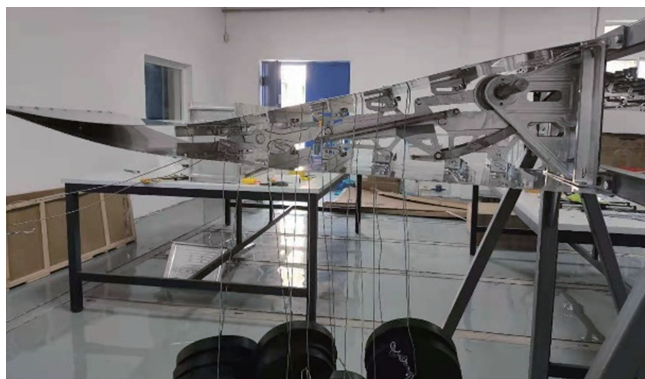
图 15 滑槽耳片后缘方案承载试验(2000N 载荷)
