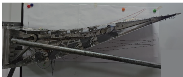
图 17 在 15° 位置时实际外形与目标外形对比
