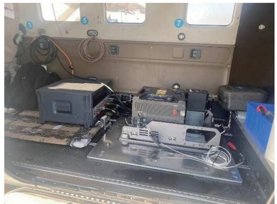
图4 直升机机载激光雷达测量系统
