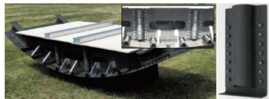
图 14 货舱地板下部吸能结构
