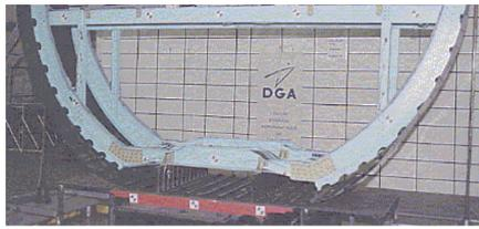
图 15 机身底部波纹梁吸能结构
