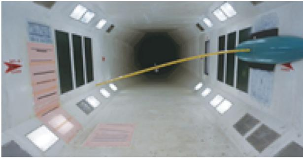
图 11 机翼模型风洞试验
