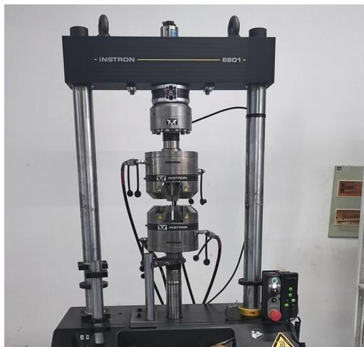
图5 Instron 8801 疲劳试验机
