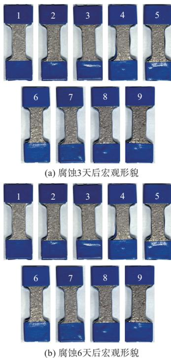
图8 2.8mT磁场环境下铝合金腐蚀形貌
