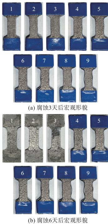
图7 1.3mT磁场环境下铝合金腐蚀形貌
