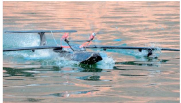
图8 北航滑行式潜水无人机
