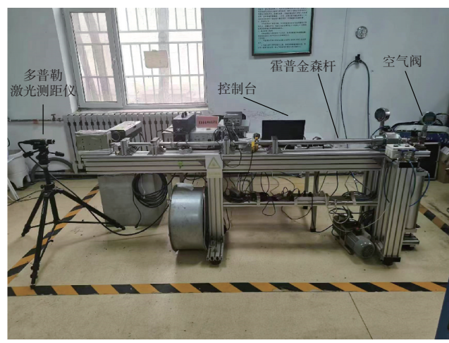
图 12 分离式霍普金森杆测试系统
