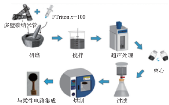
图1 碳纳米传感器的制备流程
