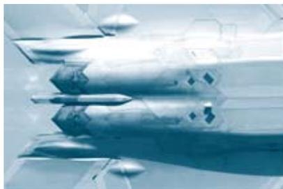
图7 F-22飞机上每一条缝隙均平行于特定角度
