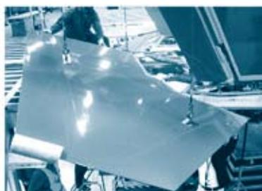
图8 F-35飞机光洁如镜的复合材料平尾
