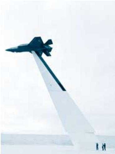
图10 隐身测试场中的全尺寸F-35飞机
