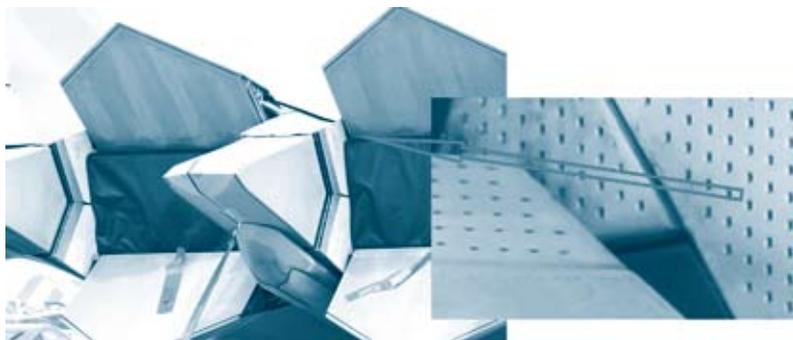
图6 F-22飞机发动机的二元可调喷口、耐高温的吸波材料、降低红外辐射的冷却气膜孔
