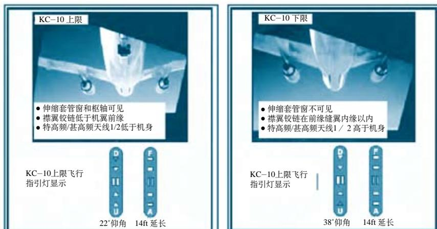
图5 KC-10伸缩套管上、下极限目视基准
