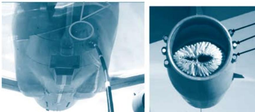
图2 KC-10中线软管加油系统及KC-135加油吊舱信号灯
