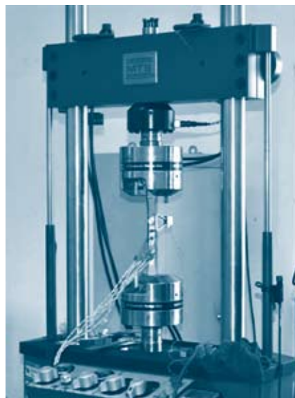
图4 试验夹持和位移-应变测量
