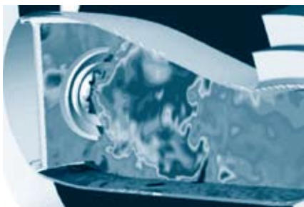
图2 SABER燃烧室火焰气动分布图
