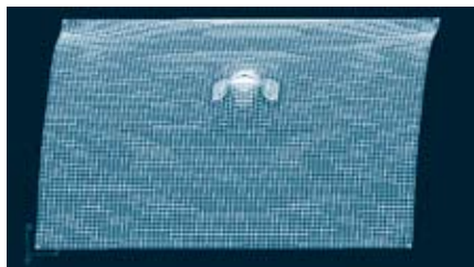
图4 曲板中间裂纹在增压载荷作用下的应力状态
