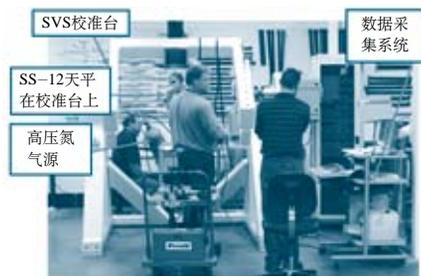
图1 NASA单矢量天平校准台
