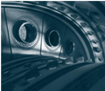
图1 第五阶段燃烧室内部结构
