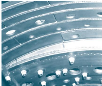
图2 V2500燃烧室的浮壁结构
