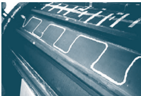
图2 粘贴于X-33航天飞机液氢燃料罐的分布式光纤传感系统
