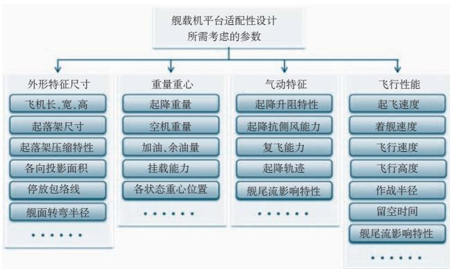
图2 舰载机平台相关适配性所涉及的参数
