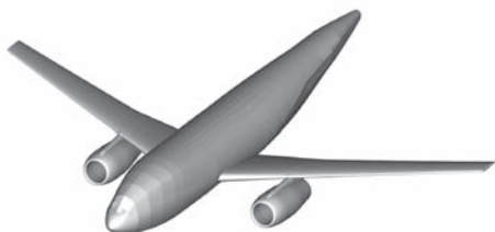
图2 DLR-F6飞机气动布局
