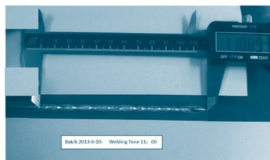
图4 楔形试片焊透长度L的测量图
