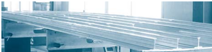
图7 预应力喷丸成形高筋整体壁板构件
