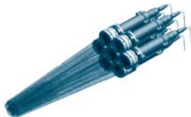
图1 含有7个子孔径的原型阵列
