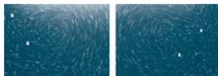
图6 有、无涡流发生器流场切面对比图
