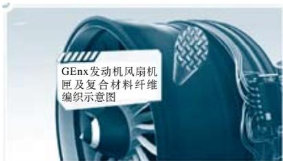
图6 GENx复合材料风扇机匣和复合材料纤维编织图
