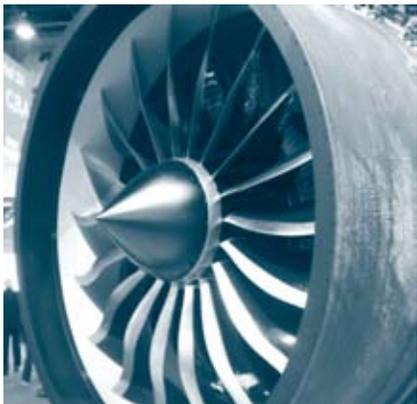
图1 GEnx复合材料风扇和复合材料风扇机匣(左)
