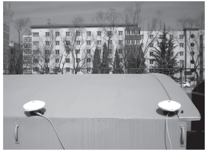
图2 GPS/BDS三频静态试验的天线安装
