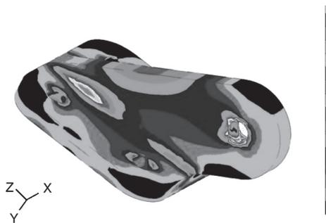
图2 武器挂梁上接头应力云图
