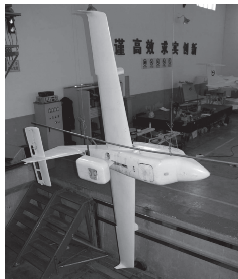
图1 悬挂模型转动惯量测量试验图
